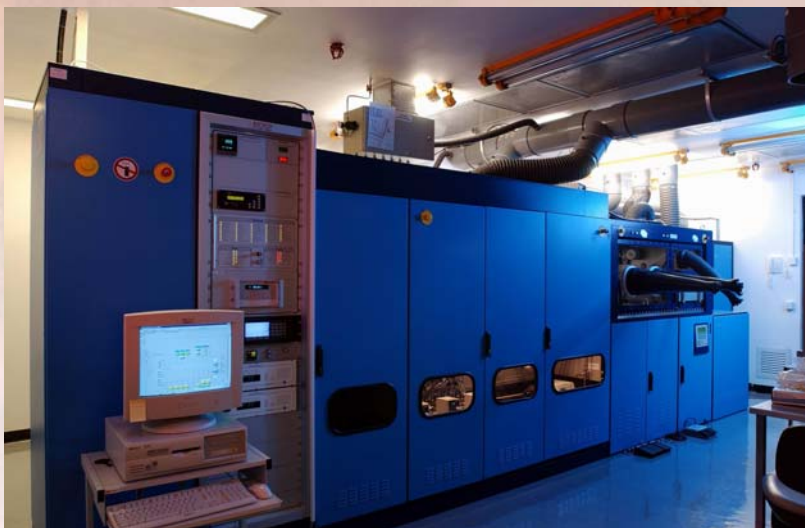
Metal-Organic Chemical Vapour Deposition (MOCVD) for LED material growth in Photonic Technology Center 有機金屬氣相沉積系統用於LED物質生長 (光電子技術中心)
